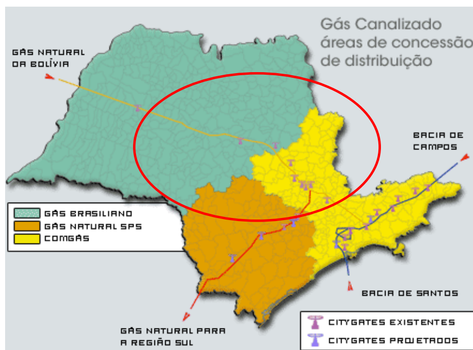
Figura 2. Malha de gasodutos do estado de São Paulo com destaque para a coincidência entre o trajeto do gasoduto e a concentração de usinas (CSPE, 2005)
